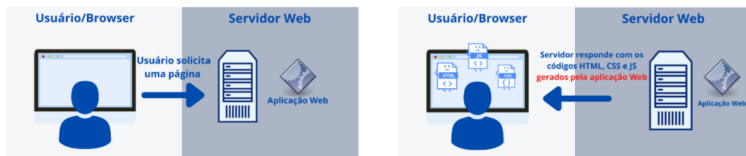
Figura 1.2: Funcionamento de um site de conteúdo dinâmico com aplicação web.
