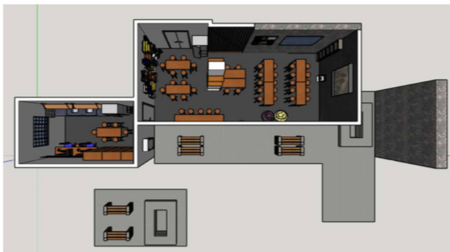
Projeção do espaço em modelagem 3D. As paredes internas de drywall são retiradas e as paredes de alvenaria não sofrem alterações.
